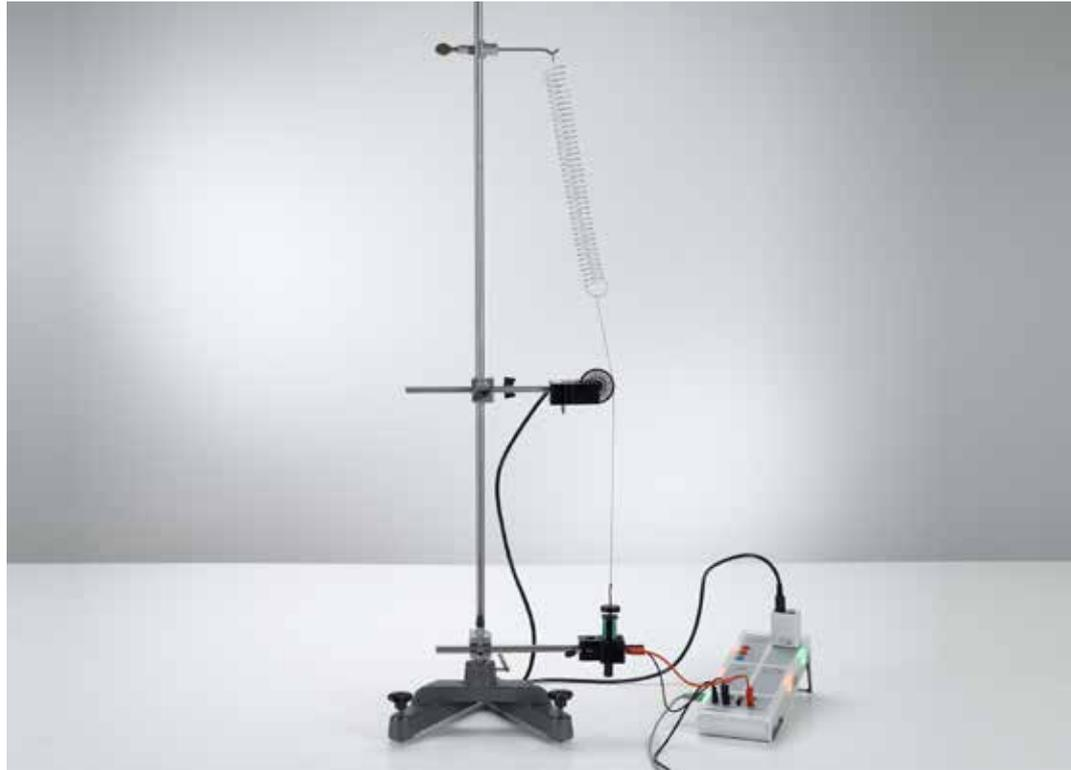
Oscilaciones de un péndulo de resorte y determinación del periodo de un péndulo de resorte en función de la masa oscilante - Medición con CASSY (P1.5.2.1)
