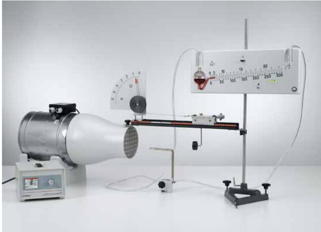
Resistencia del aire en función de la velocidad del viento y de la forma del cuerpo - Medición de presión con el manómetro fino (P1.8.6.1)
